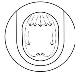
Senzabrida® fokussiert die Wasserspülung kraftvoll und minimalistisch, um somit den Spülrand beinahe vollständig zu entfernen. Die integrierte Wasserverteilung spült das WC hygienisch und effektiv aus und dient gleichzeitig als ästhetische und geräuscharme Reduzierung auf das Wesentliche.
