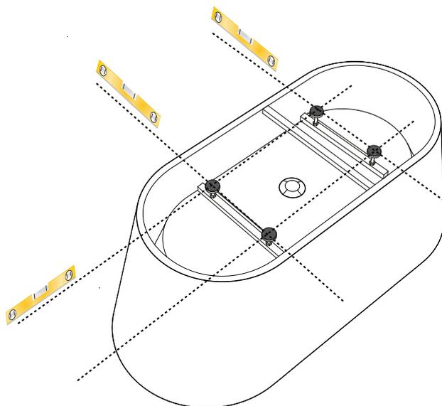
Sotto la vasca, sono presenti 4 piedini regolabili. Appoggiando un regolo sulla parte inferiore del bordo, regolare l'altezza di ogni piedino fino a toccare il regolo svitando o avvitando a seconda delle esigenze. In caso di dislivello del pavimento regolare ulteriormente i piedini con la vasca girata in posizione.
