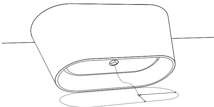
Una volta individuata la sede di installazione, predisporre lo scarico a terra in base alla relativa scheda tecnica.
