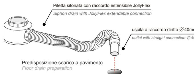
Collegare lo scarico sifonato alla predisposizione sul pavimento tramite raccordo in dotazione. *Connect the siphon drain to the preparation on the floor using supplied fitting.*
